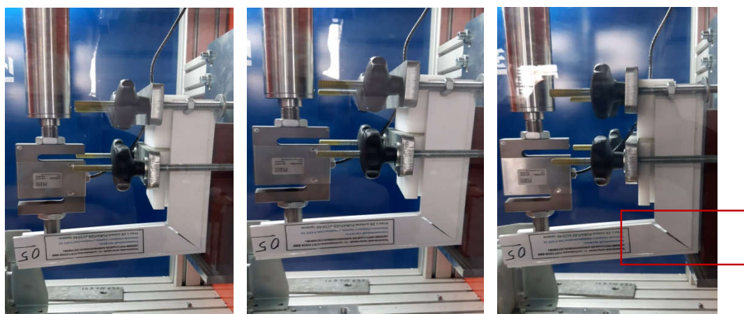
Рис.17 Полное разрушение углового соединения (углового сухаря) в образцах уголков при достижении действующих нагрузок
