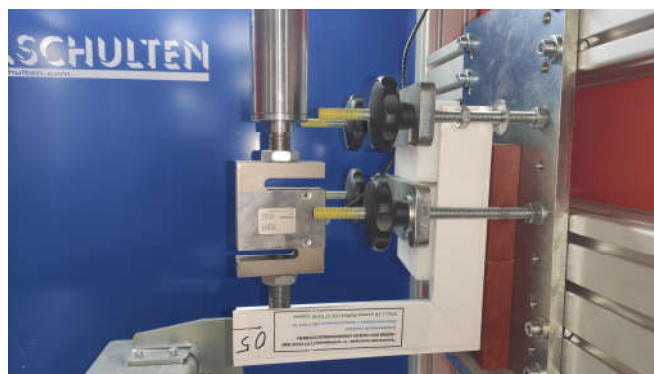
Рис.2 Испытания угловых соединений
