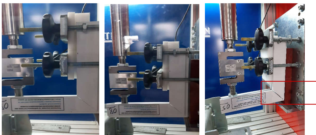
Рис.16 Разрушение клеевого соединения в образцах уголков при достижении действующих нагрузок
