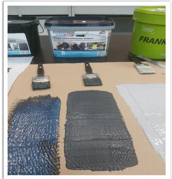
Испытуемый образец пароизоляционной жидкой ленты BLOWERPROOF (PURACOAT 6820) перед испытаниями кондиционирован 24 ч при температуре  $(23 \pm 2)$  °С и относительной влажности воздуха  $(50 \pm 10)$  % в соответствии с п.8.1. ГОСТ Р 70075—2022. Определение внешнего вида пароизоляционной жидкой ленты BLOWERPROOF (PURACOAT 6820) проводилось визуальным осмотром пробы, нанесенной на стеклянную пластину с расстояния 60 мм в согласно п.8.4 ГОСТ Р 70075-2022.
