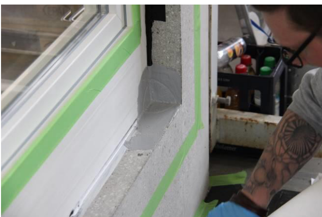
Рис. 11 Подготовка образца для испытаний, правая сторона снизу, жидкий пластик (первый слой) + армирующий флис для внутреннего угла
