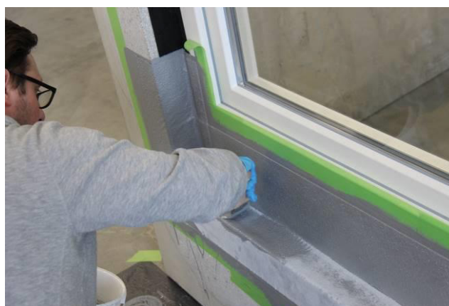
Рис. 10 Подготовка образца для испытаний, левая сторона снизу, нанесение второго слоя жидкого пластика на флис
