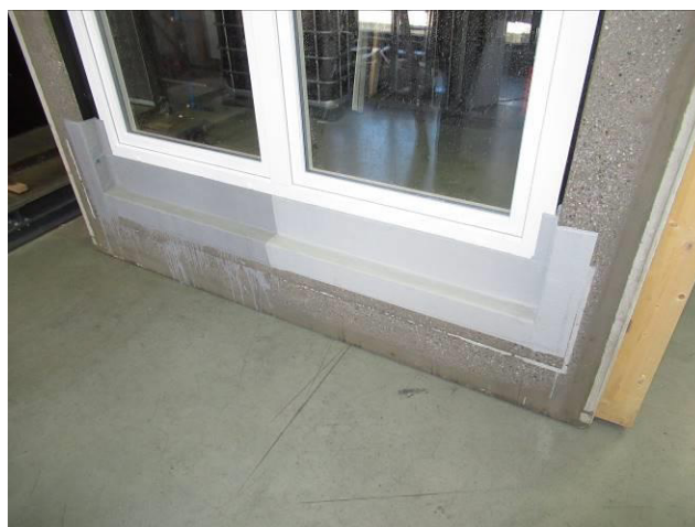
Рис. 2 Испытательный образец с двумя различными вариантами гидроизоляции (жидкого пластика)
