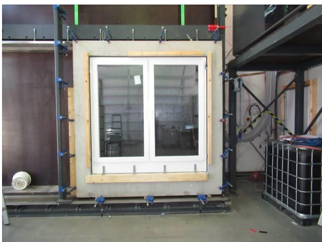
Рис. 1 Образец двухстворчатого окна VEKA для испытаний на испытательном стенде
