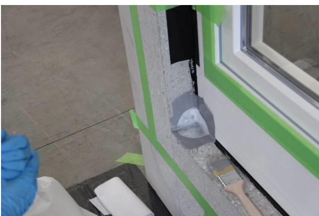
Рис. 9 Подготовка образца для испытаний, левая сторона снизу, жидкий пластик (первый слой) + армирующий флис для внутреннего угла
