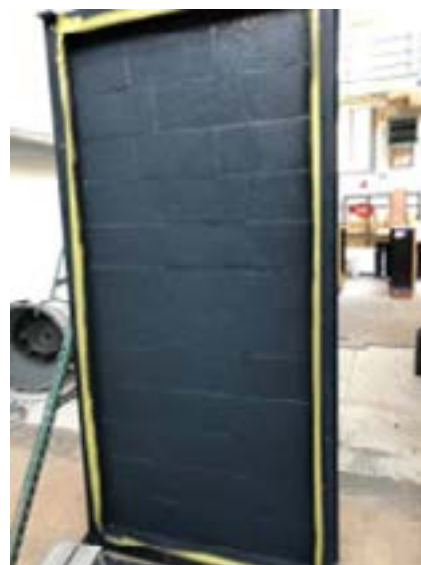
Стены с покрытием «ИЗОПРУФ ФР»
