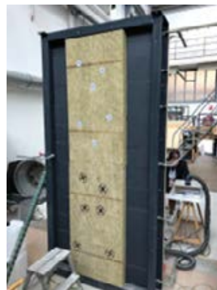
стена с «ИЗОПРУФ ФР» с 12 анкерами (6 серых «Равплаг®» и 6 черных «Эджот ДиЭйч»)
