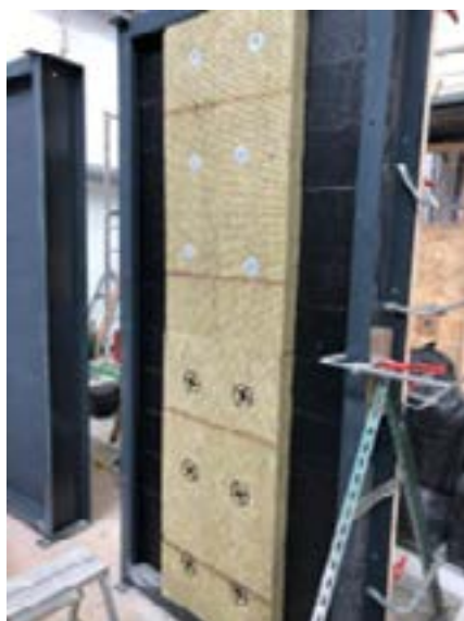
стена с «БЛОВЕРПРУФ® ЛИКВИД» с 12 анкерами (6 серых «Равплаг®» (Rawlplug®) и 6 черных «Эджот ДиЭйч»)
