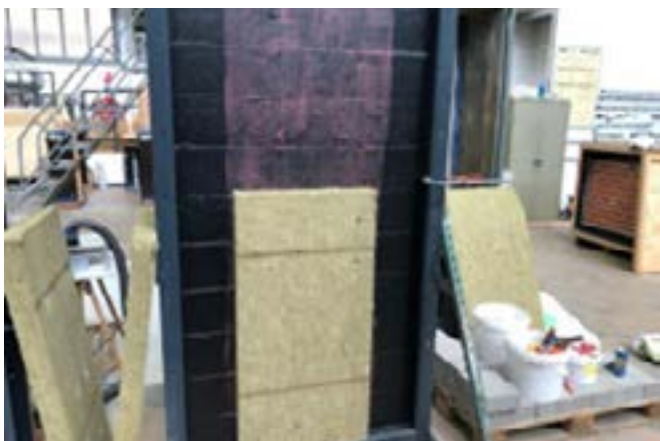
Изоляционные панели размещались на стенах
