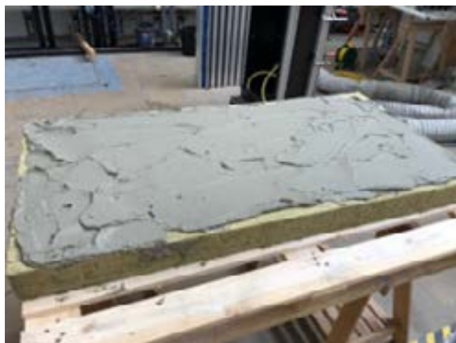
Изоляционные панели покрывались строительным раствором «РЭДАрт™ КАПА БЭЙС КАСА»
